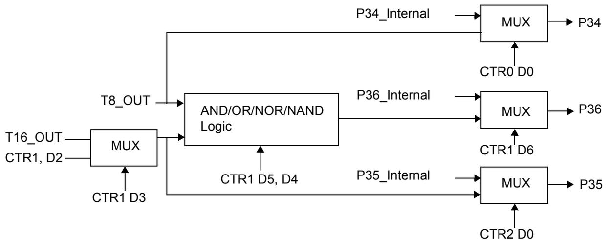
**Figure 24. Output Circuit**
