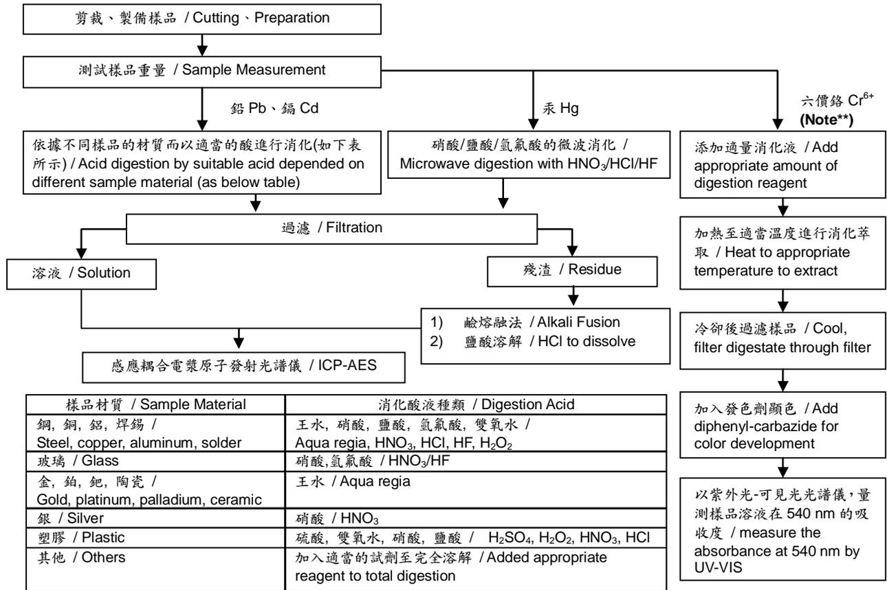
**Note\*\* :** (1) 針對非金屬材料加入鹼性消化液，加熱至 90~95°C 萃取。 / For non-metallic material, add alkaline digestion reagent and heat to 90~95°C.
