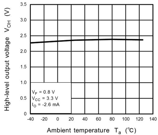
**Fig. 12.2.4**  $V_{OH} - T_a$
