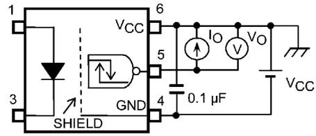
Fig. 12.1.2  $V_{OH}$  Test Circuit
