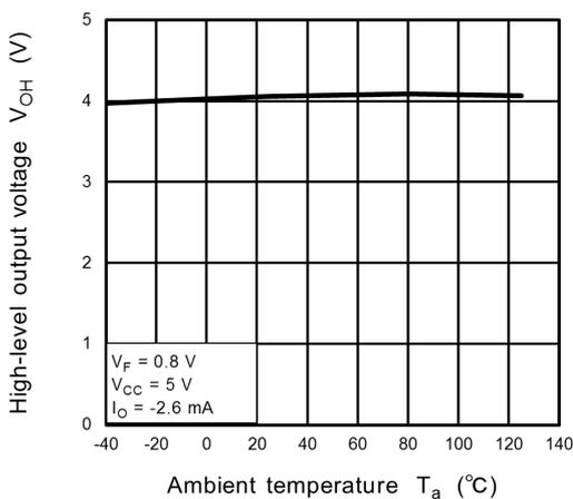
**Fig. 12.2.5**  $V_{OH} - T_a$
