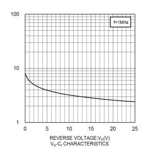
CAPACITANCE BETWEEN TERMINALS:C<sub>t</sub>(pF)
