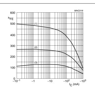
**TR2 (PNP);**  $V_{CE} = -2 \text{ V}.$
