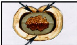
INSULATION CRIMP WINGS CONTACT THE INSULATION AT A MINIMUM OF 3 POINTS
