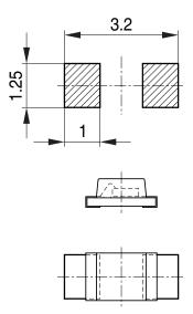
Bauteil positioniert Component location on pad OHFP2578
