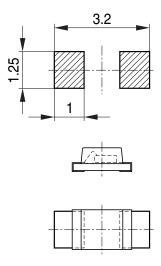
Bauteil positioniert Component location on pad OHFP2578
