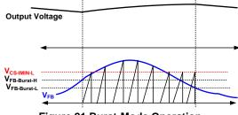
**Figure 21 Burst-Mode Operation**
