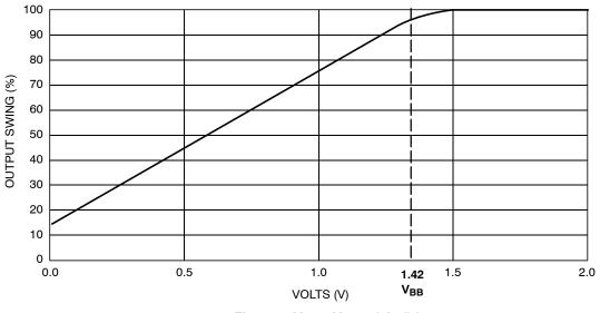
Figure 2. V<sub>CC</sub> – V<sub>CTRL</sub> (pin #1)
