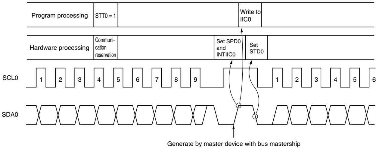
**Remark** IIC0: IIC shift register 0
