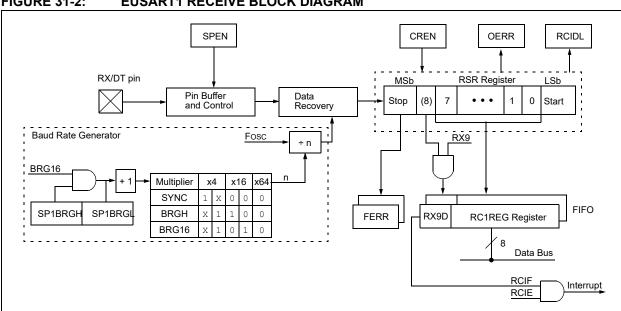
**FIGURE 31-2: EUSART1 RECEIVE BLOCK DIAGRAM**
