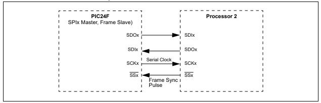
FIGURE 17-6: SPIX SLAVE, FRAME MASTER CONNECTION DIAGRAM
