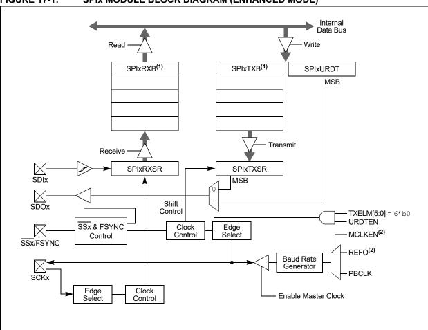
FIGURE 17-1: SPIX MODULE BLOCK DIAGRAM (ENHANCED MODE)
