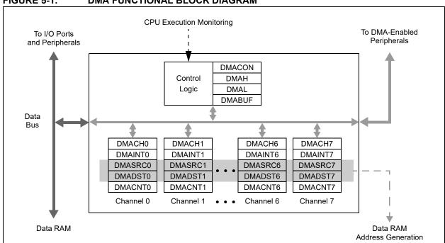
FIGURE 5-1: DMA FUNCTIONAL BLOCK DIAGRAM
