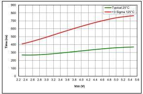
FIGURE 36-93: Comparator Response Time Rising Edge
