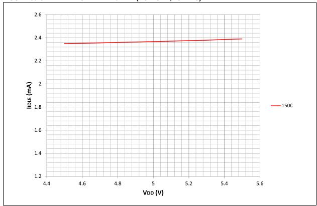
FIGURE 33-7: TYPICAL lidle vs. Vdd (EC MODE, 20 MIPS)
