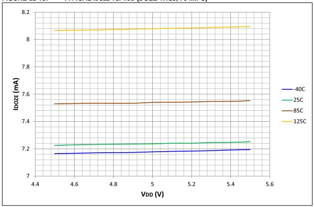
FIGURE 32-16: TYPICAL/MAXIMUM IDOZE vs. TEMPERATURE (DOZE 1:128, 70 MIPS)
