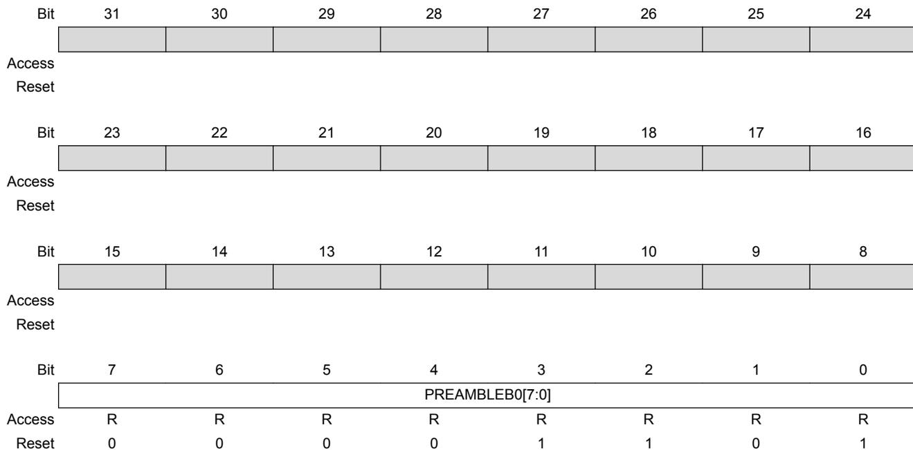
**Bits 7:0 – PREAMBLE0[7:0]** Preamble Byte 0
