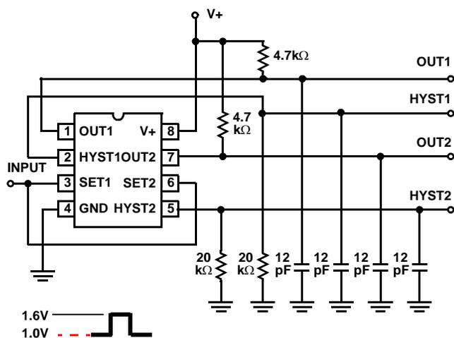
FIGURE 7. TEST CIRCUITS
