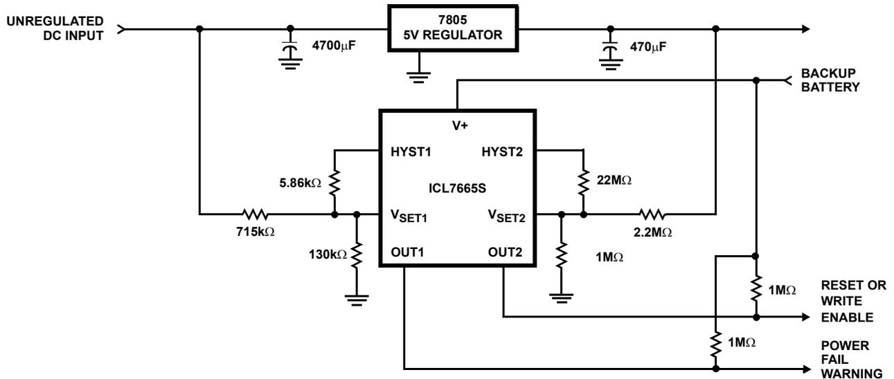
FIGURE 15. POWER FAIL WARNING AND POWERUP/POWERDOWN RESET
