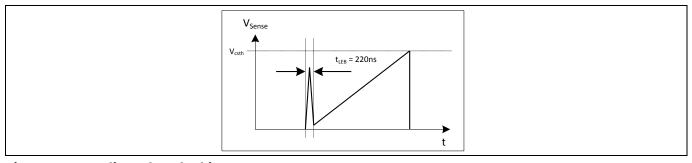
Figure 19 Leading Edge Blanking
