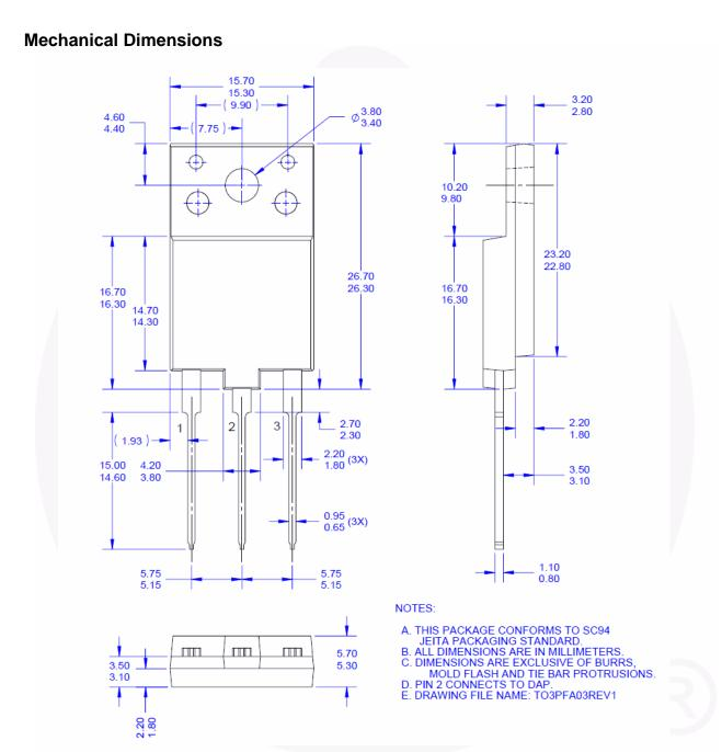
Figure 18. TO3PF,MOLDED,3LD,FULLPACK (AG)
