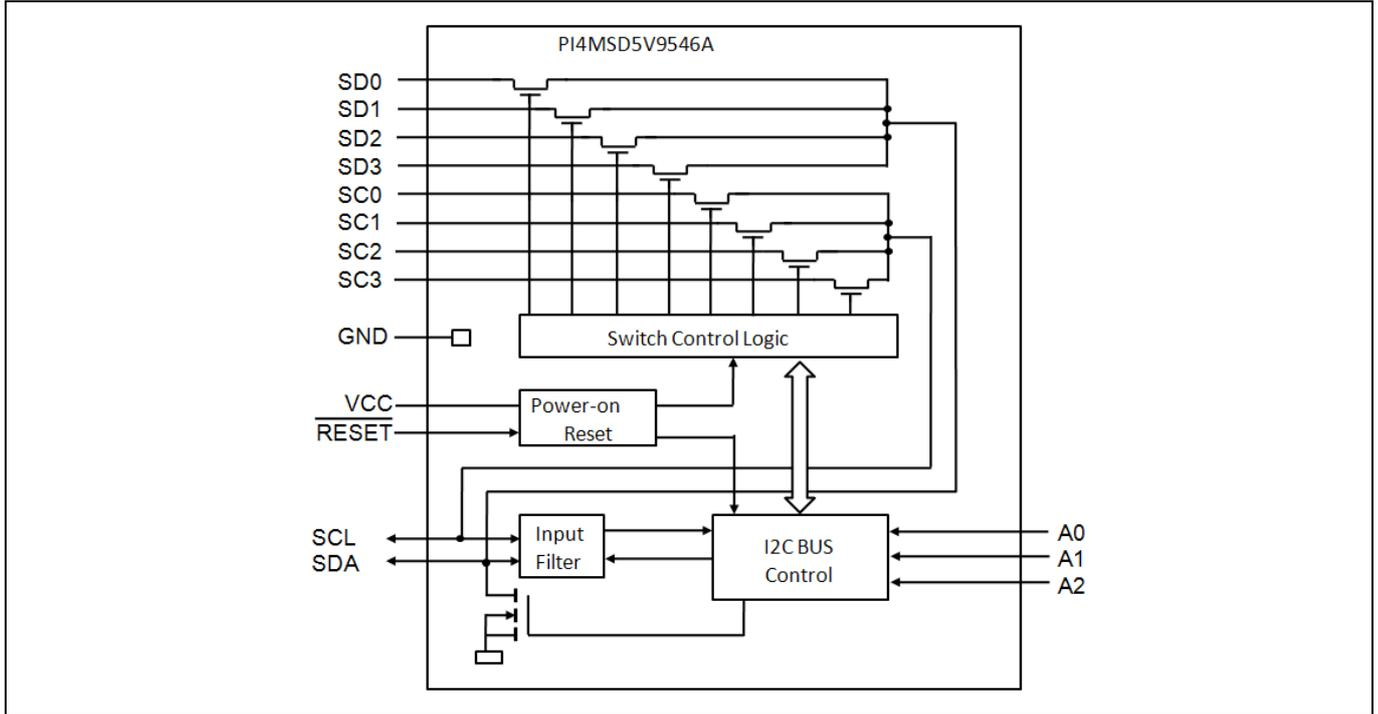
**Figure 1. Block Diagram**
