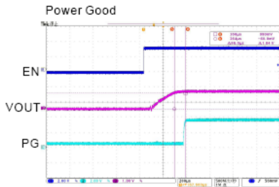
V_{in}=3.3\text{V} , V_o=1.2\text{V} , I_o=1\text{A}
