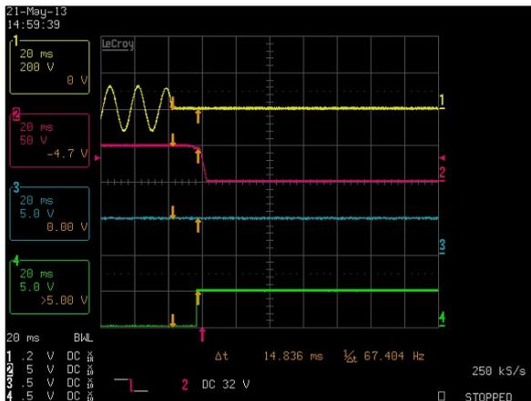
Figure 58: LCM1500W-T-4 Hold-up Time
