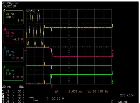
Figure 59: LCM1500W-T-4 Hold-up Time
