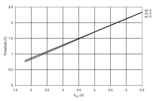
Figure 20-92.  $V_{IH}$ - $V_{IL}$ : Input Hysteresis vs.  $V_{CC}$  (Reset Pin)
