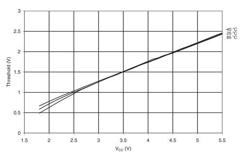
**Figure 20-89.**  $V_{IH}$ - $V_{IL}$ : Input Hysteresis vs.  $V_{CC}$  (I/O Pin)
