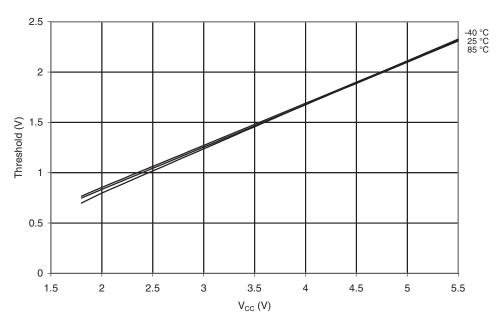
Figure 20-143. $V_{IH}$ - $V_{IL}$ : Input Hysteresis vs.  $V_{CC}$  (Reset Pin)
