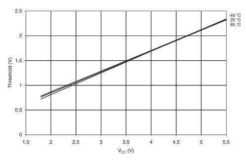
Figure 20-41.  $V_{IH}$ - $V_{IL}$ : Input Hysteresis vs.  $V_{CC}$  (Reset Pin)
