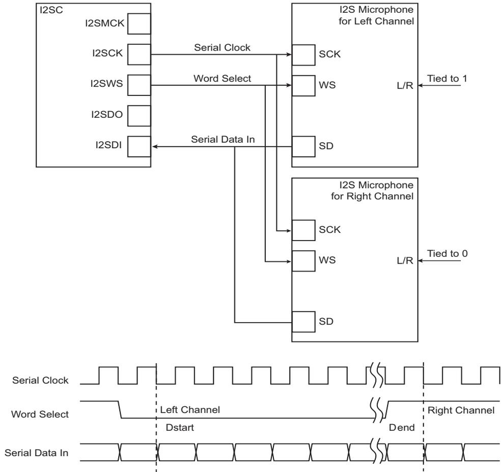
**Figure 44-7. Codec Application Block Diagram**
