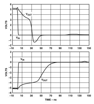
TPC 32. Overload Recovery;  $V_S=\pm 6~V,~G=+2,~R_L=100~\Omega,~V_{IN}=5~V~p\text{--}p,~T=1~\mu\text{s}$
