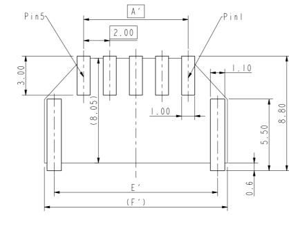
RECOMMENDED PCB LAYOUT: COMPONENTS SIDE TOLERANCE:  $\pm 0.05$
